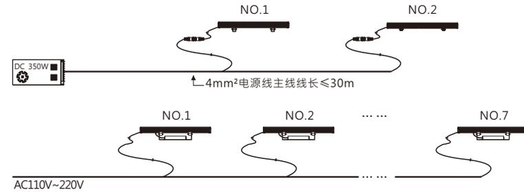
注: 单色常亮·DC灯具每个电源单回路可并联2个灯具·且电源连接灯具总数量不要超过电源功率的80%。
