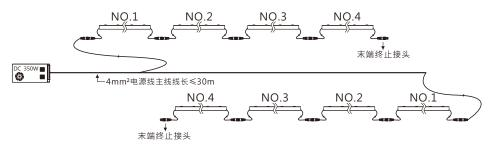
注:单色常亮·灯具每个电源单回路可串联4支灯具·且电源连接灯具总数量不要超过电源功率的80%。 上图示意中灯具为72灯19W·灯与灯之间的线长不超过1米。
