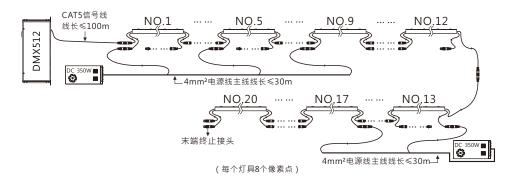
注:DMX控制·灯具每个电源单回路可串联4支灯具·且电源连接灯具总数量不要超过电源功率的80%。每个信号回路灯具连接数量不可超过170个像素点。 上图示意中灯具为72灯19W·灯与灯之间的线长不超过1米。
